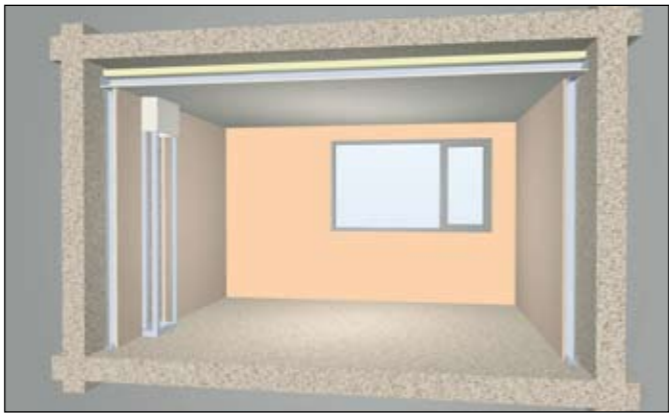
Afbeelding 6.4: Vrijstaande voorzetwanden
