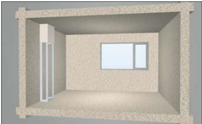
Afbeelding 6.2: Leidingkoker deels beplaat
