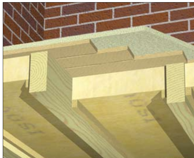
Isoleren van een houten begane grond vloer
