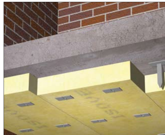
Isoleren van een massieve (beton) begane grond vloer vanuit de kruipruimte
